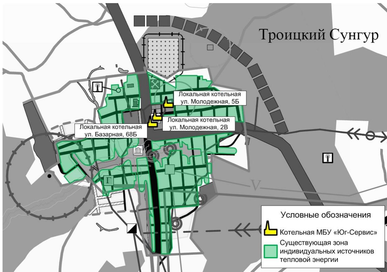
Рисунок 1.1.1.1 – Зоны действия локальных котельных и индивидуальных источников тепловой энергии, находящихся в частной собственности жителей, с. Троицкий Сунгур
